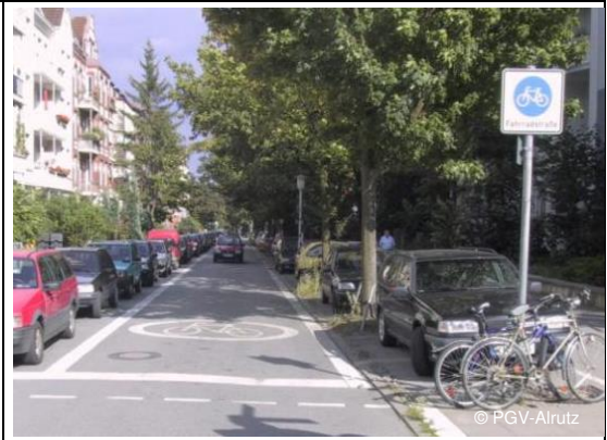
Beispiel Kiel Fahrradstraßen mit Fahrbahnrandmarkierung und großem Piktogramm an allen Knotenpunkten
