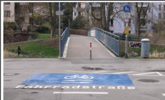
Beispiel Freiburg Piktogramme in Blau mit zusätzlichen Richtungspfeilen an allen Einmündungen
